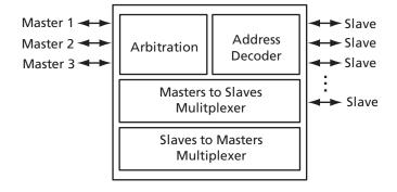
Figure 1 • CoreAHB Block Diagram
