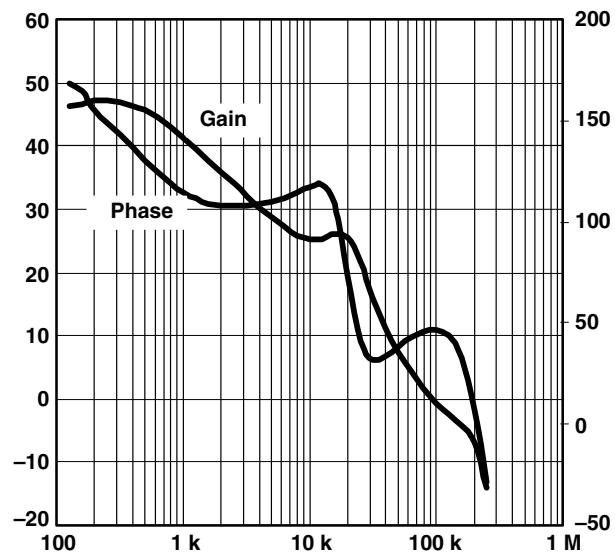
図2-11. ループ応答、TPS54810、 $V_{IN} = 4V$
