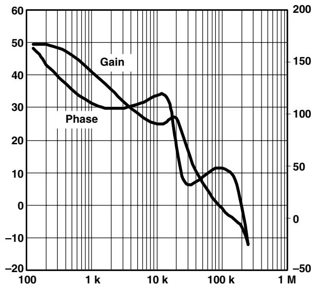
図2-13. ループ応答、TPS54910、 $V_{IN} = 3V$
