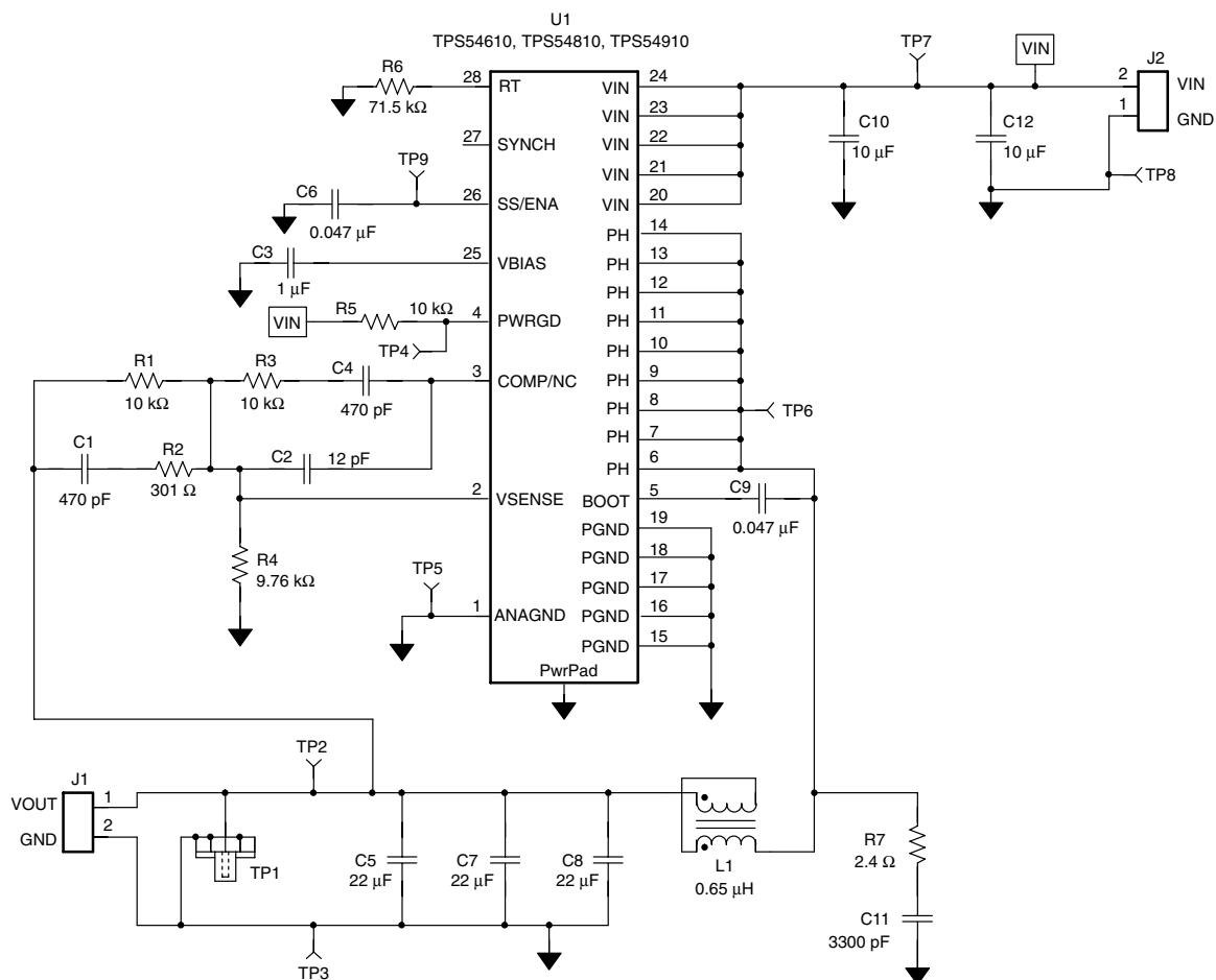
アナログ・グラウンドおよび電源グラウンドは、ICパッケージの下でPowerPADに接続されています。
