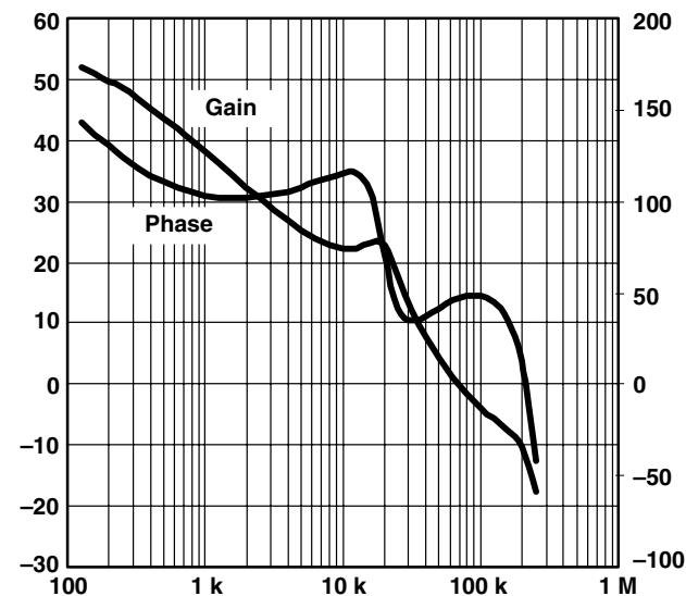
図2-12. ループ応答、TPS54810、 $V_{IN} = 6V$
