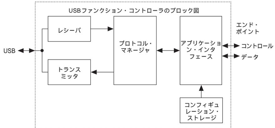
デバイスおよびエンド・ポイント・ディスクリプタ用コンフィギュレーションROMコードのストアにはFLEX 10Kのエンベデッド・アレイ・ブロック (EAB) が使用され、アプリケーションによってはFIFOのようなストレージ・バッファとしても実現することができます。
