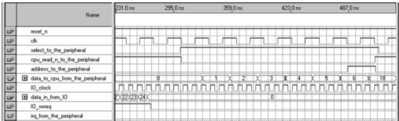
図 4 FIFO ペリフェラルのシミュレーション例
