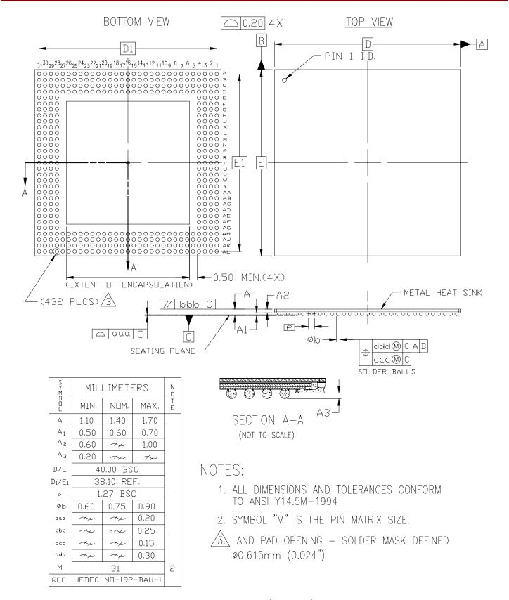
432-BALL PLASTIC BGA (BG432) - CAVITY DOWN
