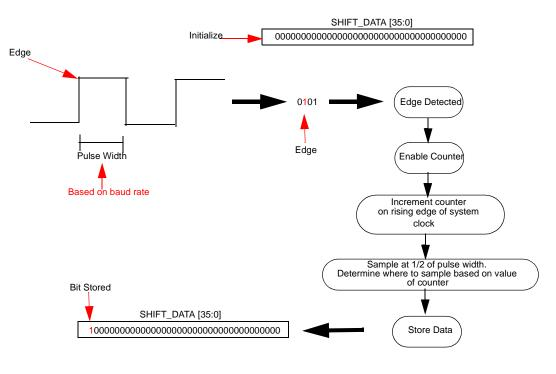
Figure 10: Receive Edge Detection
