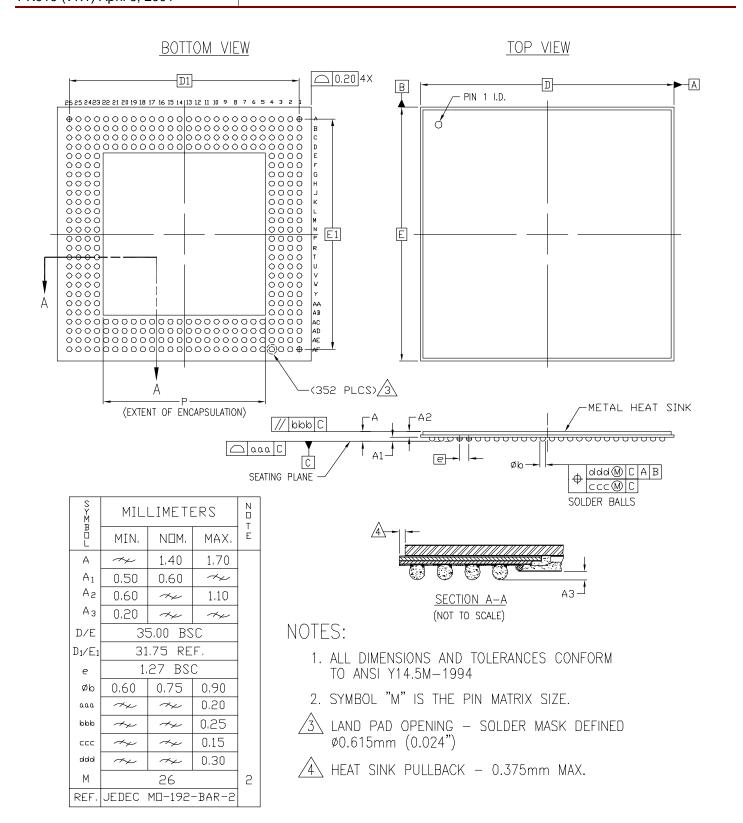
352-BALL METAL BGA (BG352) - CAVITY DOWN
