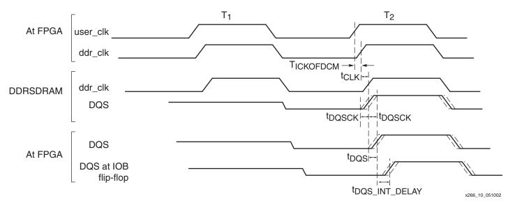
Figure 10: Clock to DQS Output Delay Time
