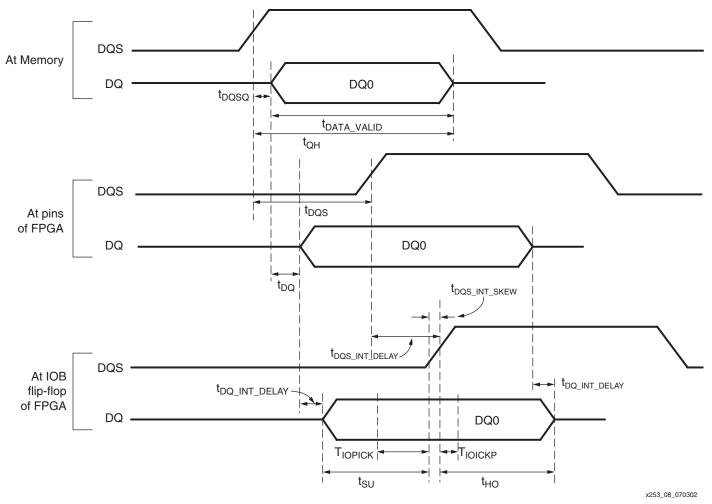
Figure 8: DQS and DQ Signals
