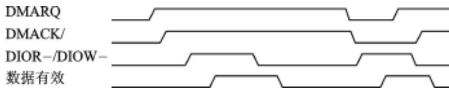
图 1.15-3 IDE 接口时序(多字 DMA 模式)
