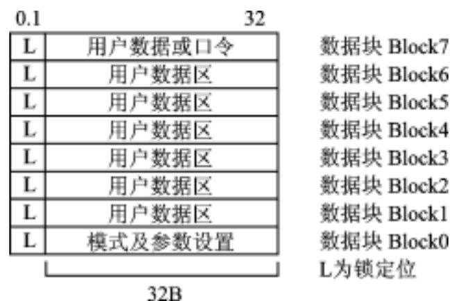
图 5.12-1 E5550 存储器结构
