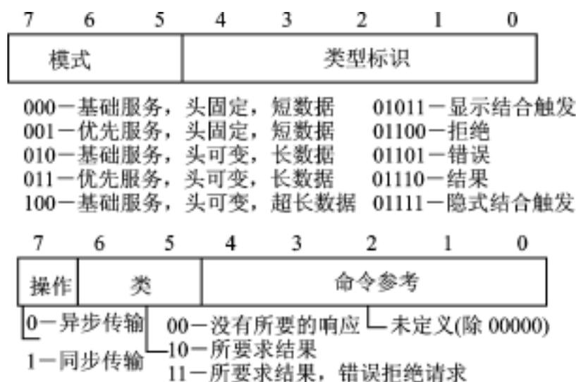
图 6.10-7 APDU 的组成结构
