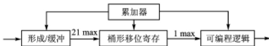
(b) 不规则算法的专用结构示例: 变字长解码器
