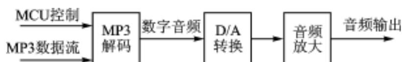
图 5.11-1 MP3 播放机的结构
