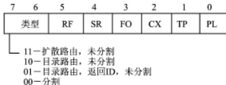
图 6.10-6 NPDU 的组成结构
