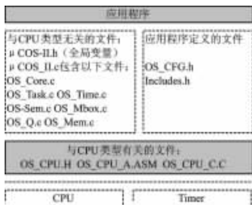
图 3.10-1 \mu\text{C}/\text{OS}-\text{II} 的文件结构
