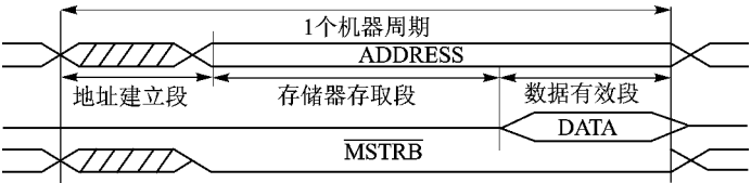
图 8.2-1 DSP 读外部存储器的时序图
