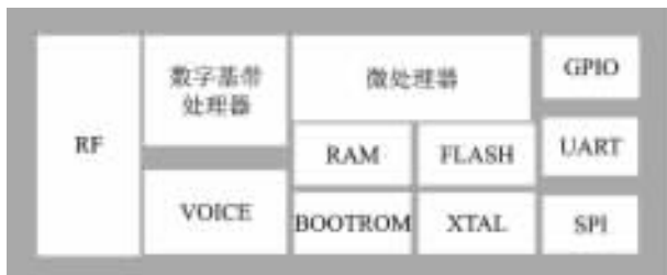
图 1.4 - 4 单芯片蓝牙 SoC 系统框图
