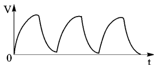
图 7.16-1 传输线上电容引起的畸变
