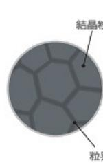
磁性セラミックスであるフェライトは多結晶体。焼成工程で、結晶粒の周囲に高抵抗の粒界が形成される。
