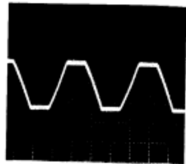
<사진1>Capacitor C 4 의 전류파형 (20V/div, 10μs/div)
