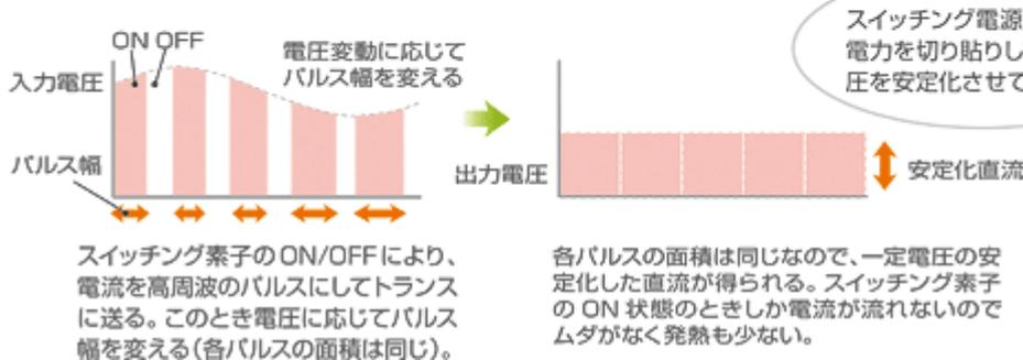
スイッチング電源は、いわば電力を切り貼りして、出力電圧を安定化させている。
