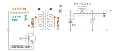
●スイッチONすると、トランスの原理により1次巻線・2次巻線に起電力(逆起電力、誘導起電力)が発生して、ダイオード(D1)を通じて電流が流れる(→)。このとき、チョークコイルにエネルギーが蓄えられる。
