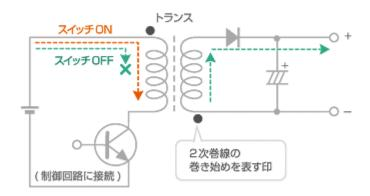
●スイッチON すると、1 次巻線に電流が流れ、発生する磁束によりコアが磁化される (エネルギーの蓄積)。ダイオードの向きが逆なので、2 次巻線には誘導電流が流れない。
