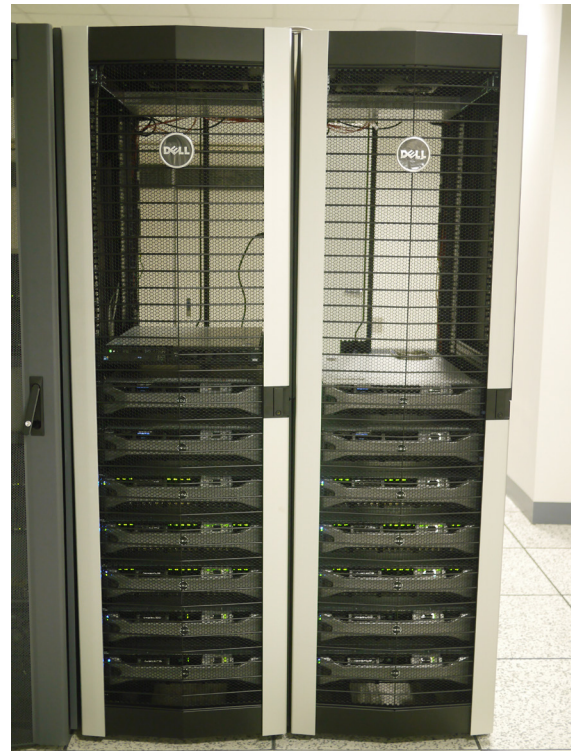
국가핵융합연구소의 스토리지 인프라를 맡게 된 델 컴펠런트 SC8000. 액티브-액티브 방식의 이중화 구성으로 성능과 가용성을 모두 잡았다.
