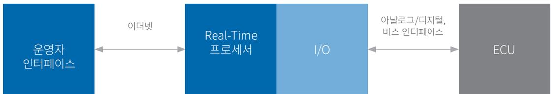
그림 1. HIL 테스트 시스템은 운영자 인터페이스, 실시간 프로세서 및 I/O 인터페이스의 세 가지 주요 컴포넌트로 이루어져 있습니다.
