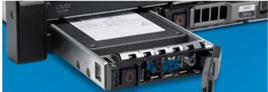
Dell PowerEdge R720 서버의 착탈식 PCIe 플래시 카드
