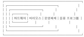
바이오스는 롬(ROM)에 들어 있기 때문에 흔히 롬바이오스라고 부르죠. 롬 은 읽을 수만 있고 쓸 수는 없다는 뜻의 Read Only Memory의 줄임말입니 다. 컴퓨터 부팅시 <Del>키 누르면 나오는 CMOS 셋업 프로그램과 주변기기 초기화, 자체 진단 루틴도 이 롬바이오스에 같이 포함되어 있습니다. 롬에는 쓰기가 불가능하기 때문에 장착된 주변기기에 대한 정보를 저장하려면 쓰기를 할 수 있는 다른 공간이 필요하겠죠. 그리고 저장한 것은 컴퓨터의 전원이 없어도 사라져서는 안됩니다. 그곳이 바로 CMOS입니다. 우리가 CMOS 셋업 프로그램을 이용해 장착된 주변 기기에 대한 정보를 알려주면 바이오스는 그것에 기초하여 하드웨어를 인식하고 제어할 수 있게됩니다.
