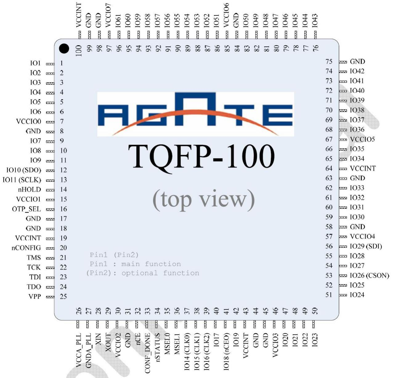
图 2-1 TQFP-100 引脚图
