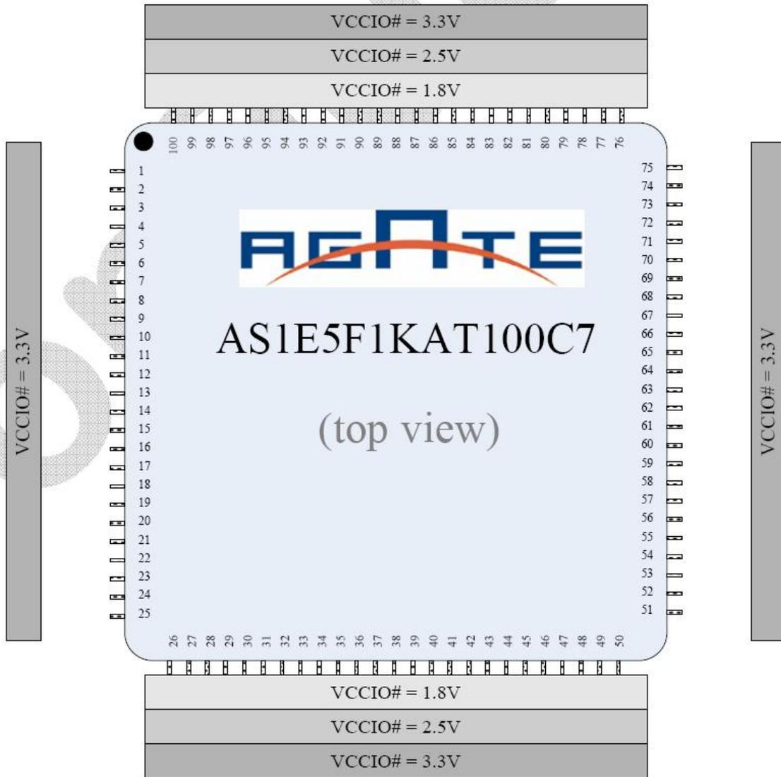
图 3-2 T100 带 Flash 用户 I/O 电源的电压限制
