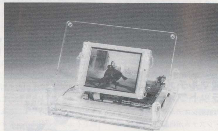
●図2 ザイリンクスの Spartan-II FPGA と CoolRunner CPLD をボード上に搭載した Acunia 社の車載システム開発プラットフォーム
