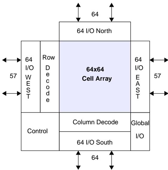
Figure 23. XC6216 Block Diagram
