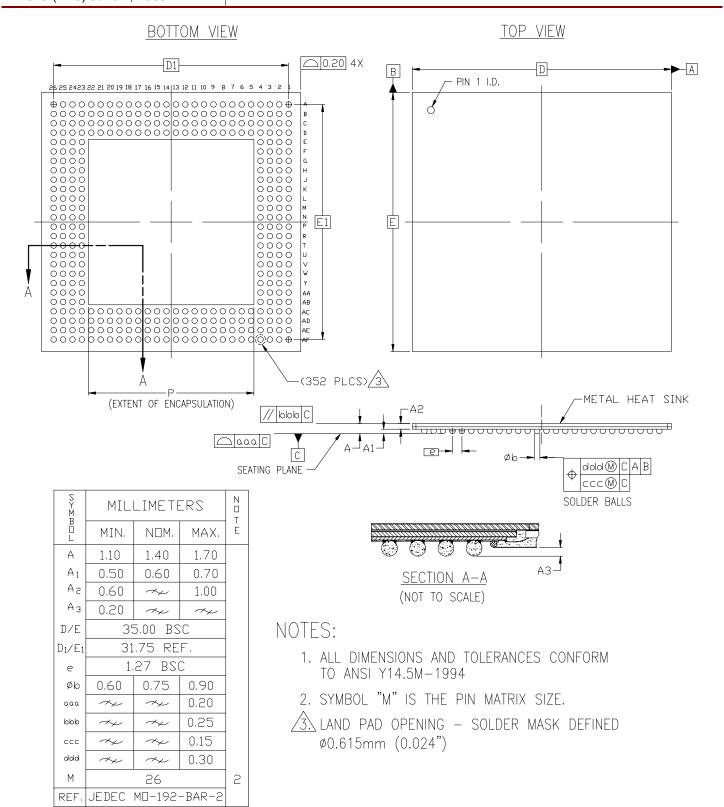
352-BALL PLASTIC BGA (BG352) - CAVITY DOWN
